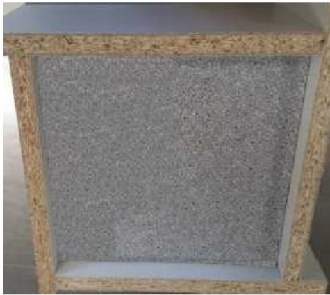
Photo 1 – coffrage d'éprouvette PSE pour coulage du béton
