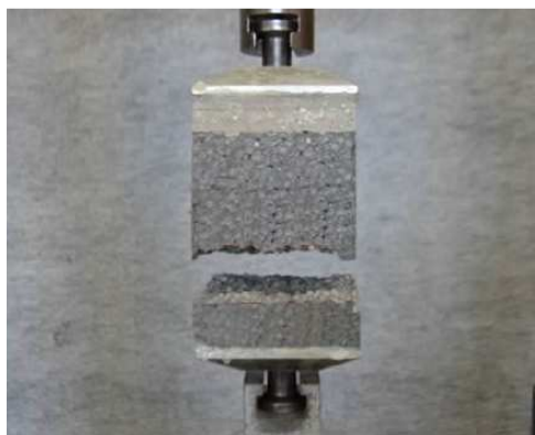
Photo 3 - exemple de rupture cohésive
